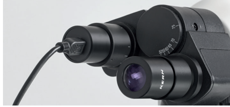
Okularkamera am Tubus befestigt
