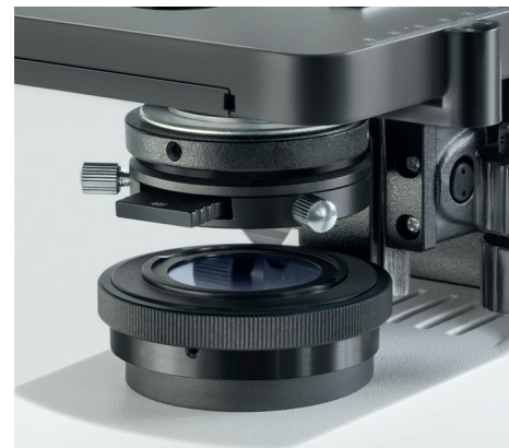
Condensatore a contrasto di fase montato
