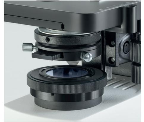
Condenseur de contraste de phase monté
