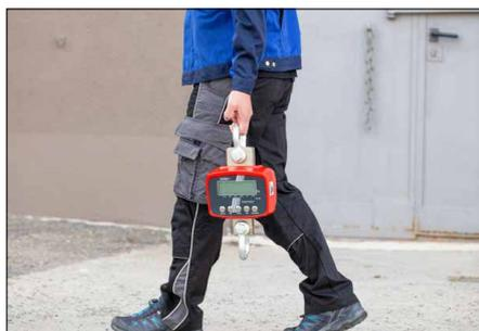
Hohe Mobilität: Dank Akkubetrieb und kompakter, leichter Bauweise geeignet zum Einsatz an mehreren Standorten (Produktion, Lager, Versand, etc.)
