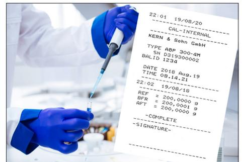
GLP/ISO-Protokollierung: professionelles und ausführliches GLP-Protokoll, damit ist die Waage vollständig konform zu den entsprechenden Normanforderungen gemäß ISO, GLP und GMP
